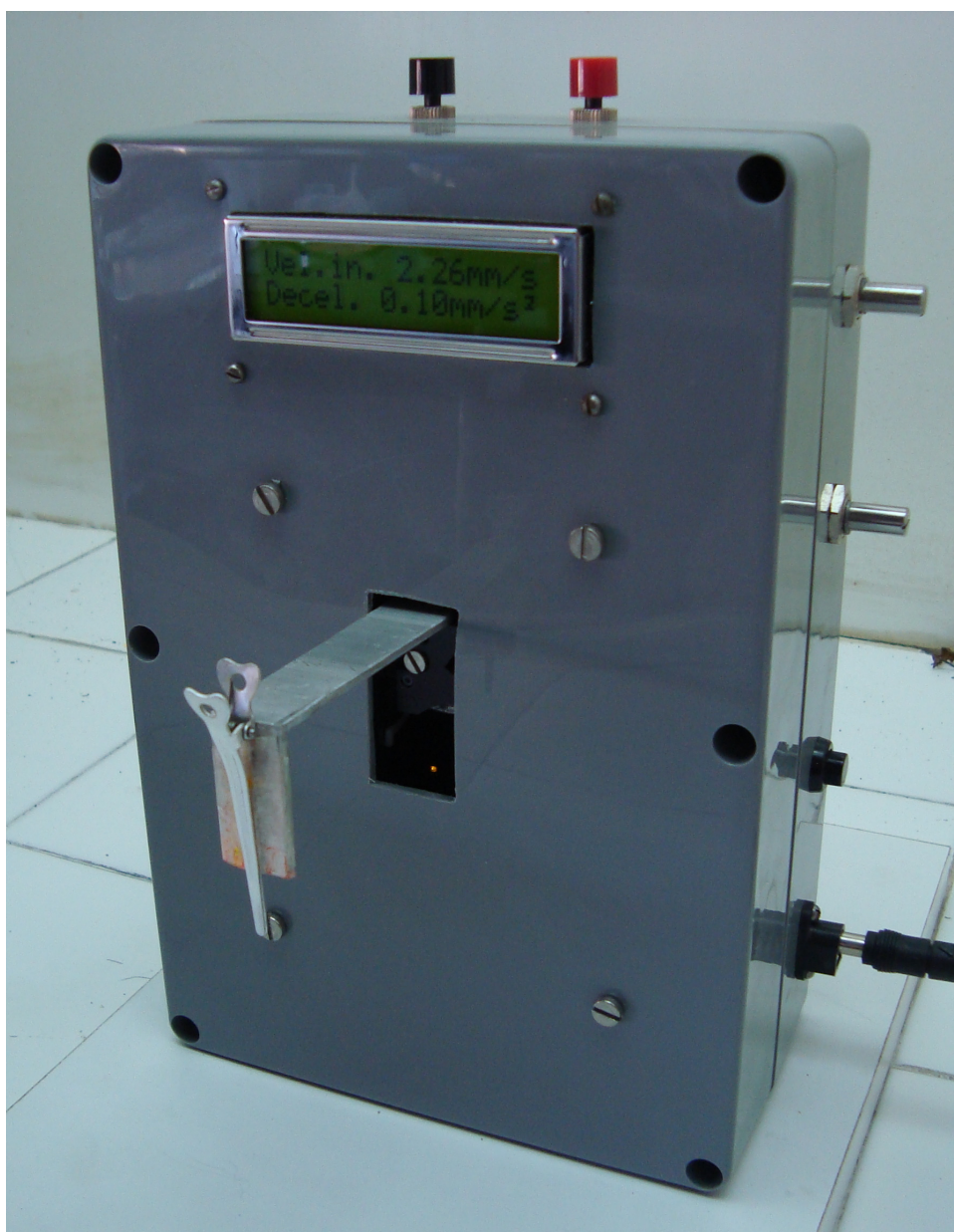
Figura 5.8: Il dip-coater completo.
