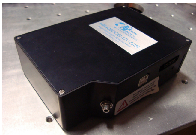
Figura 3.3: Spettrometro Ocean Optics HR4000CG-UV-NIR con in evidenza il connettore a vite per il fissaggio della fibra ottica esterna.
